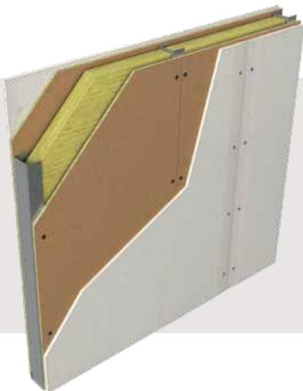
Fornitura e posa in opera di parete a secco costituita da orditura metallica e rivestimento di chiusura composto da pannelli tecnici in legno denominati **Superpan Build, marcati CE** secondo UNI EN 13986, **classe tecnica P5** secondo UNI EN 312 (pannello per utilizzo come componente strutturale in ambiente umido **classe di servizio 2** secondo UNI EN 1995-1) rivestiti con lastre di cartongesso. Lo spessore complessivo sarà di circa 124 mm.
