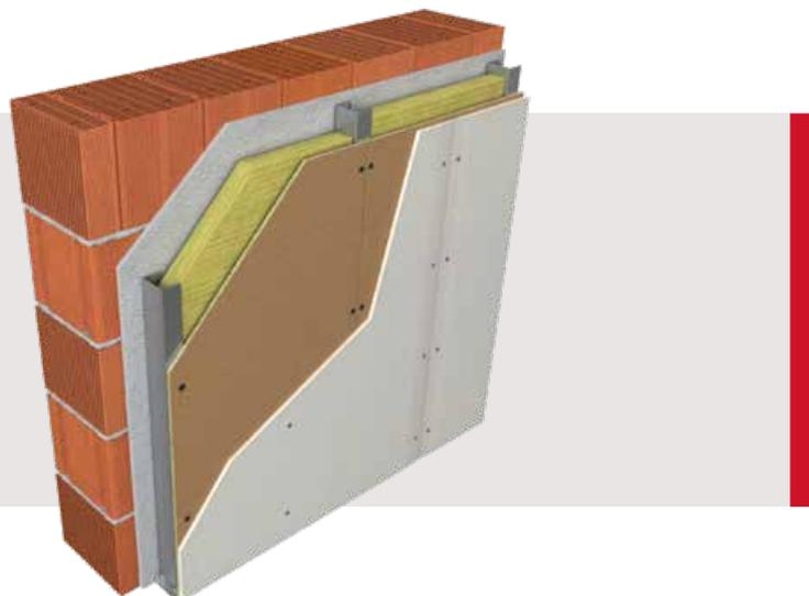
Fornitura e posa in opera di controparete a secco costituita da orditura metallica e rivestimento di chiusura composto da pannelli tecnici in legno denominati **Superpan Build, marcati CE** secondo UNI EN 13986, **classe tecnica P5** secondo UNI EN 312 (pannello per utilizzo come componente strutturale in ambiente umido **classe di servizio 2** secondo UNI EN 1995-1) rivestiti con lastre di cartongesso. Lo spessore complessivo sarà di circa 75 mm (100).
